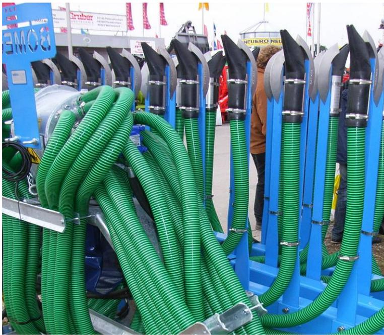
**Figur 5: Moderner Schleppschlauchverteiler mit Kufen, um das Gülleband besonders bodennah abzulegen, ähnlich wie beim Schleppschuh**
