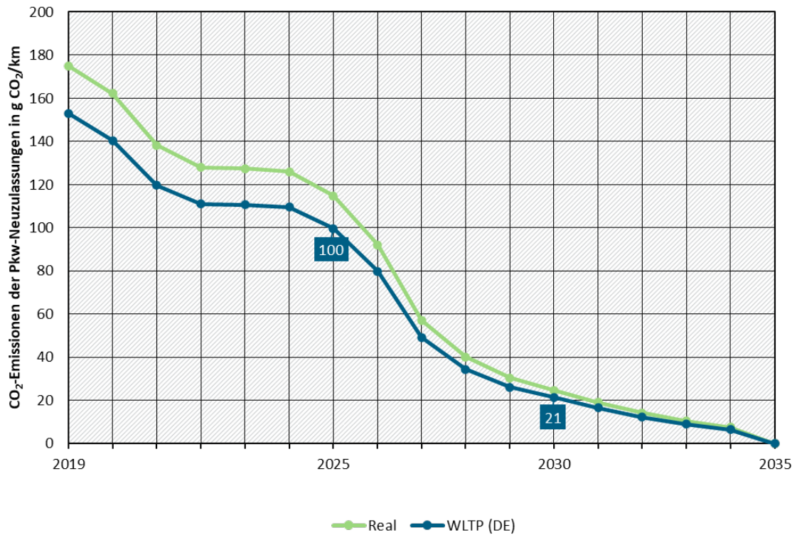
Abbildung 13: Durchschnittliche CO 2 -Emissionen neu zugelassener Pkw im SHS
