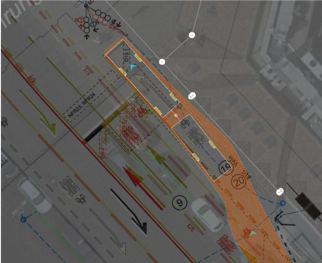
Legende: Warteposition GTB vor dem Wenden, auf dem Radstreifen ist eine lichte Breite von 1.70 m vorhanden; Zustand nach Umsetzung der Sofortmassnahme Bahnhof-Bollwerk; Quelle: RK&P, Bauprojekt Sofortmassnahme Bahnhof-Bollwerk, 16.11.2022
